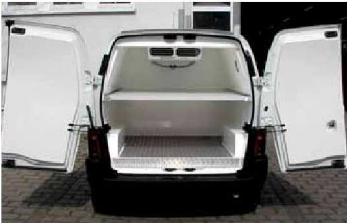
Der Citroën Berlingo mit Kühlhausbau von Wükaro./ The Citroën Berlingo with refrigerated box assemblies by Wükaro.
