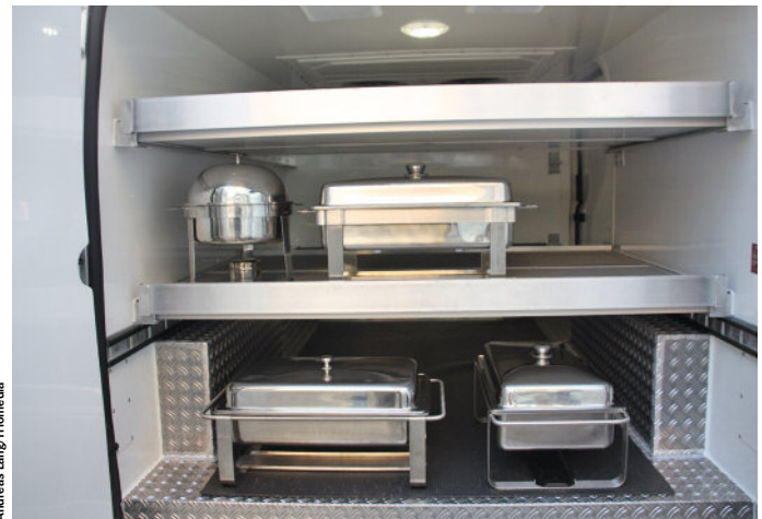
Die raue Beschichtung der Zwischenböden und die Anti-Rutsch-Matte sorgen für einen sicheren Transport der Platten und Behälter im Partyservice.
