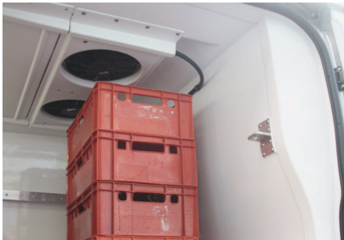
Maximale Ladekapazität: Dank des verwendeten Flachverdampfers geht im Innenraum des Fahrzeugs praktisch kein Platz an das Kühlsystem verloren.
