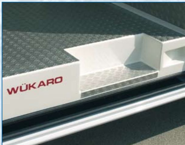
Ein- oder zwei Reihen eingelassene Aluminium-Scheuerleisten (gegen Aufpreis lieferbar).
