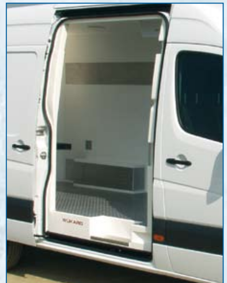
Ein- oder zwei Reihen eingelassene Aluminium-Scheuerleisten (gegen Aufpreis lieferbar).
