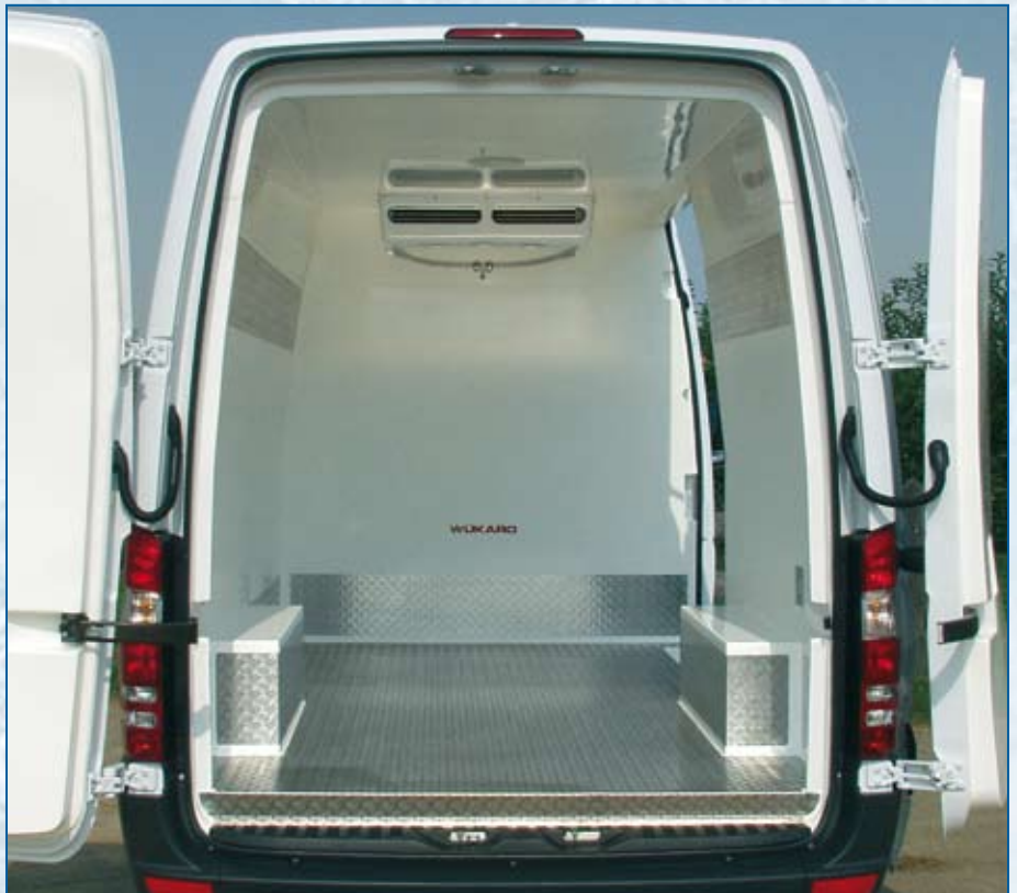
Ein- oder zwei Reihen eingelassene Aluminium-Scheuerleisten (gegen Aufpreis lieferbar).
