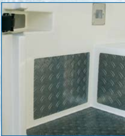
Vertiefung für Türhaltebänder mit Stoßschutz aus Edelstahl und Druckentlüftung für Laderaum.*
