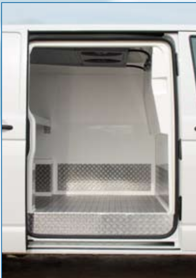
Herausnehmbarer Zwischenboden als zweite Ladefläche.
