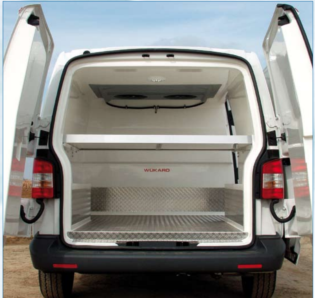
Herausnehmbarer Zwischenboden als zweite Ladefläche.
