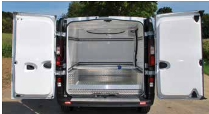
Renault Trafic mit vollintegrierter Kühlanlage.
