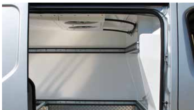
Mit der vollintegrierten Kühlanlage beim Renault Trafic gibt es keinen Platzverlust im Laderaum.
