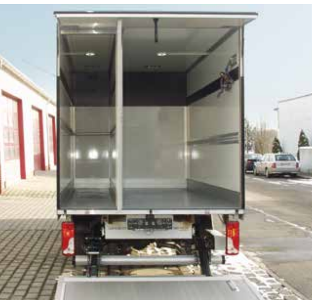
Oben: Kofferaufbau mit transluzentem Dach. Leicht isolierter Verteilerkoffer mit Trennwand und Ladebordwand für den Transport von Lebensmitteln.
