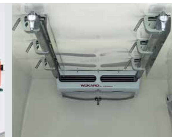
Innenausstattung mit Eurorohrbahnen.
