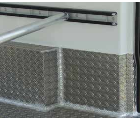
Sonderausstattung: Verschweißte Bodenwanne und Ladungssicherungssysteme.
