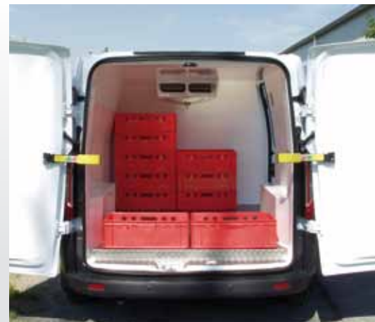
Die optimale Beladung mit zwei E2-Kisten quer ist durch ein angepasstes Radkastenmaß möglich.
