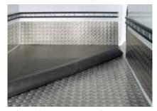
Scheuerleisten aus Aluminium in Verbindung mit Zurrleisten bieten optimalen Schutz des Ausbaus und zusätzliche Sicherheit beim Transport.
