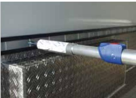
**Sockelscheuerleisten aus Aluminium in Verbindung mit Zurrleisten bieten optimalen Schutz des Ausbaus und zusätzliche Sicherheit beim Transport.**
