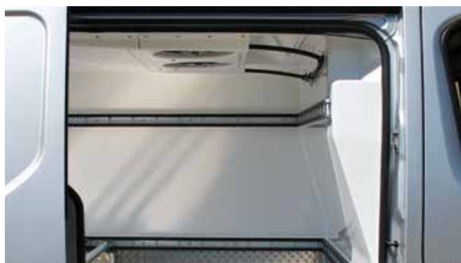
Mit der vollintegrierten Kühlanlage beim Renault Traffic gibt es keinen Platzverlust im Laderaum.
