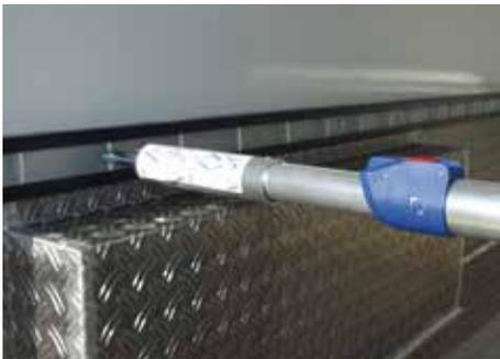
**Sockelscheuerleisten aus Aluminium in Verbindung mit Zurrleisten bieten optimalen Schutz des Ausbaus und zusätzliche Sicherheit beim Transport.**
