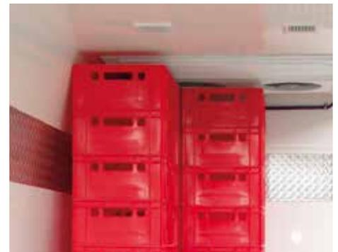
**Mit der vollintegrierten Kühlanlage gibt es keinen Platzverlust mehr im Laderaum.**
