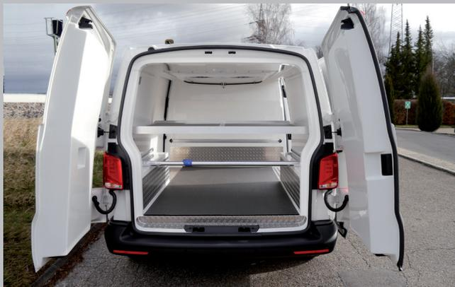
Heckansicht mit Ladungssicherung und Zwischenboden.
